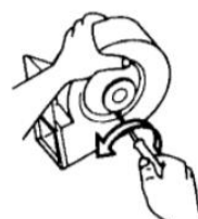
Figur 10. Fläkthjulet lossas från flätkåpan genom att demontera skruvarna på flätkåpans sida.
